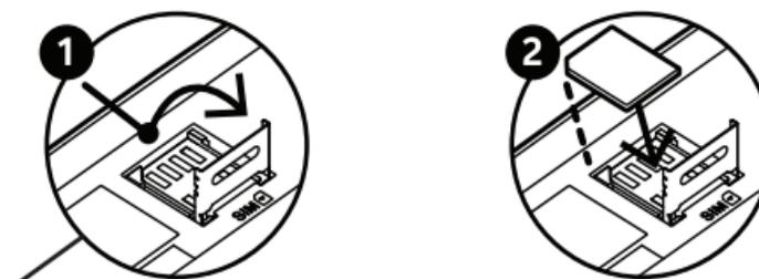
Ziehen Sie den Schlitten leicht nach hinten, um die Verriegelung zu lösen und zu öffnen.
